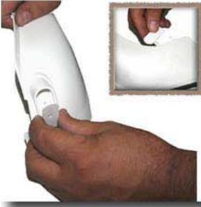
**STEP 6** - Fissare con le apposite viti i fari posteriori, senza eccedere nel serraggio
